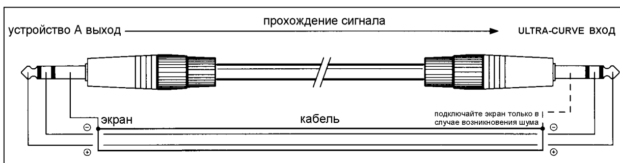
Рисунок 4.5: Сбалансированное подключение ко входу ULTRA-CURVE при помощи четвертьдюймовых джеков
