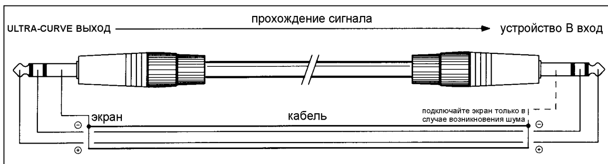
Рисунок 4.6: Сбалансированное подключение к выходу ULTRA-CURVE при помощи четвертьдюймовых джеков
