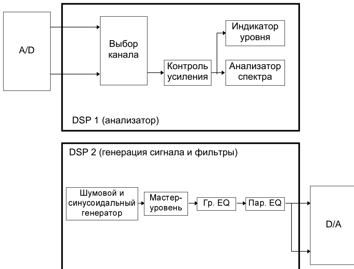
Рисунок 3.2: Блок-диаграмма работы программного обеспечения ULTRA-CURVE в режиме анализатора спектра
